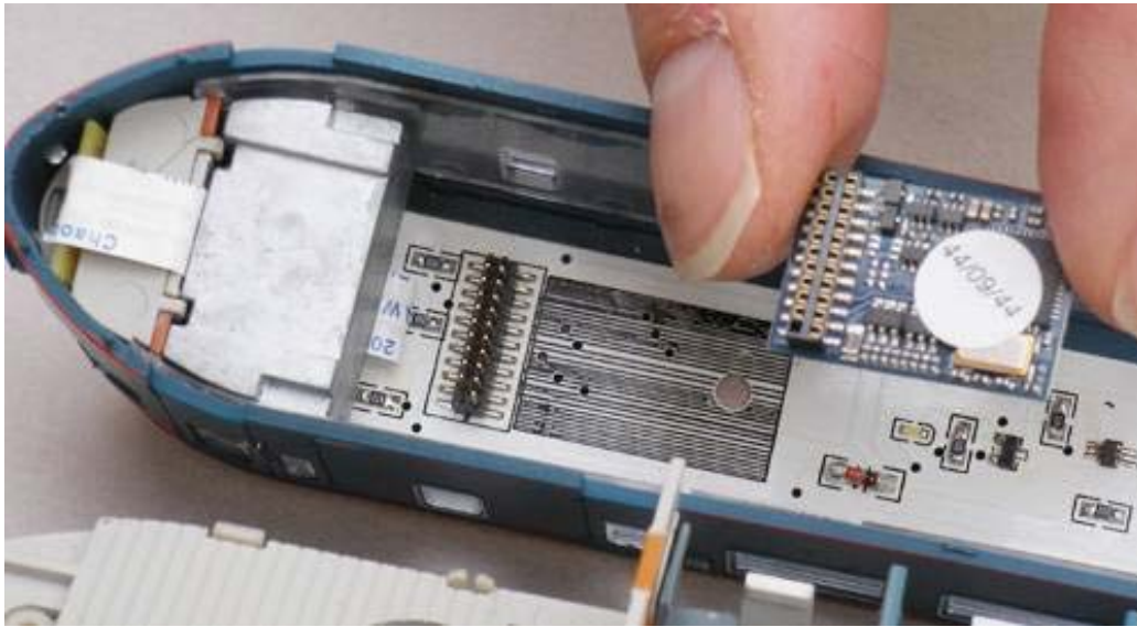
Foto 15 Plaats uw vinger op de STEKKER en duw de decoder voorzichtig op de pinnetjes van de printplaat.
