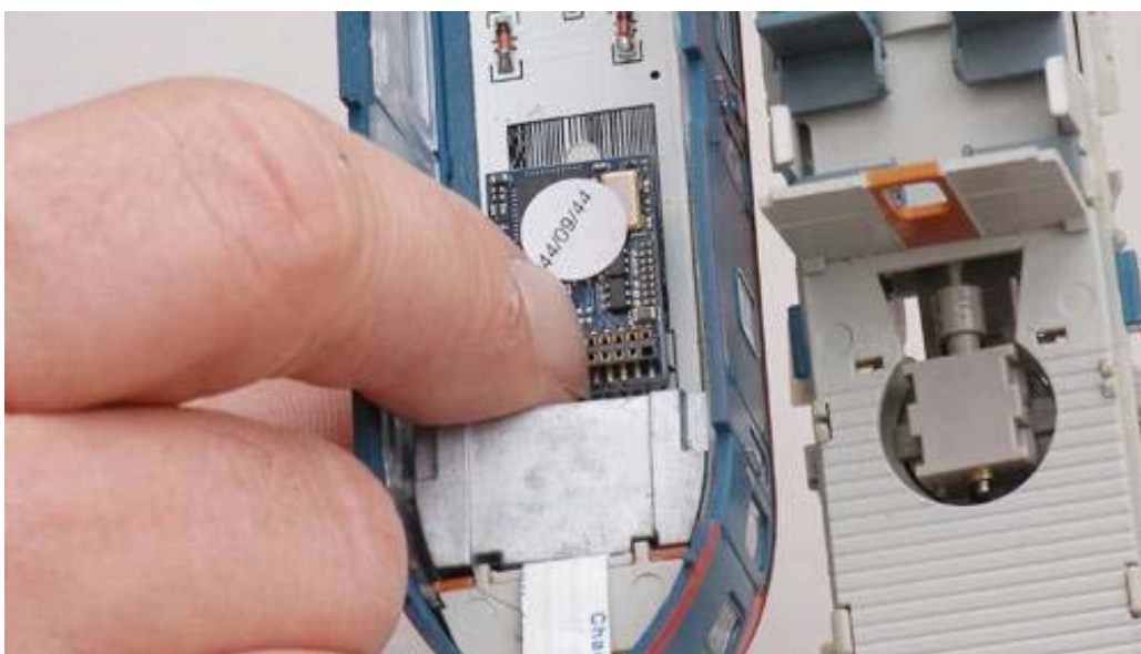
Foto 15: Mit dem Finger auf dem Stecker, den Decoder vorsichtig an die Platine schieben und befestigen.
