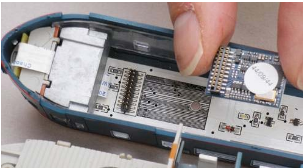
Foto 15: Mit dem Finger auf dem Stecker, den Decoder vorsichtig an die Platine schieben und befestigen.
